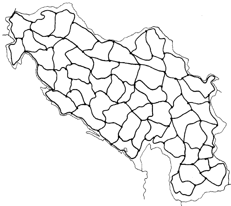
Slika 1.7. Osnovna gravimetrijska mreža bivše SFRJ.
