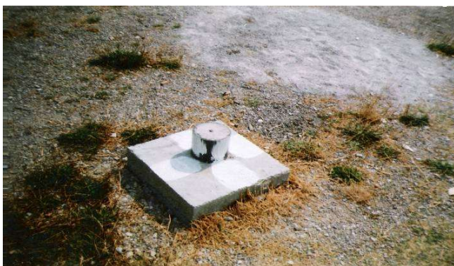
Slika 1.3. Način stabilizacije tačaka državne referentne GPS mreže.
