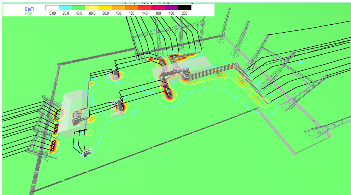
Slika 4.4. Trafostanica TS 400/110/35 kV Lastva: Trodimenzionalni model - magnetna indukcija B u \mu\text{T} na 1 m iznad tla uključujući 200 \mu\text{T} izoliniju (opšta javna izloženost)
