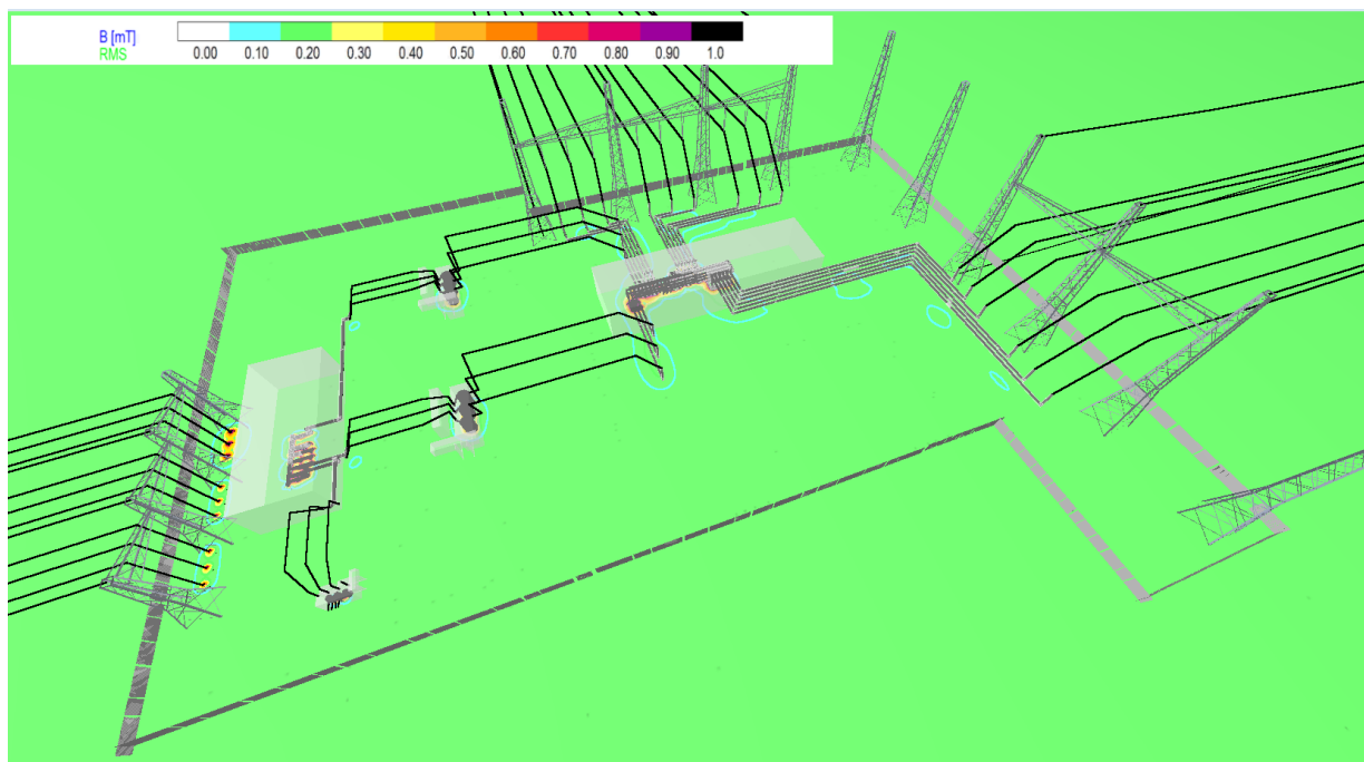
Slika 4.6. Trafostanica TS 400/110/35 kV Lastva: Trodimenzionalni model - Magnetna indukcija B u \mu\text{T} na 1 m iznad tla uključujući 1 mT izoliniju (profesionalna izloženost)
