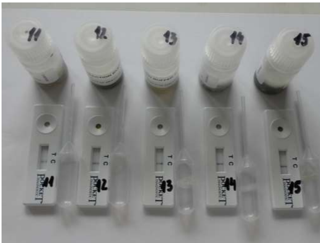
Sl.4: Rezultati “lateral flow device” (LFD) testa koji su dobijeni testiranjem uzoraka br. 11 do 15
