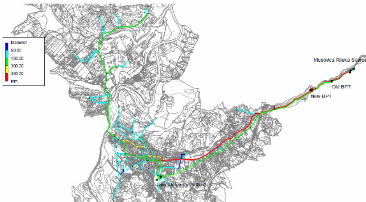
Slika 1.9/4: Šema vodovodnog sistema Kolašina iz EPANET modela
