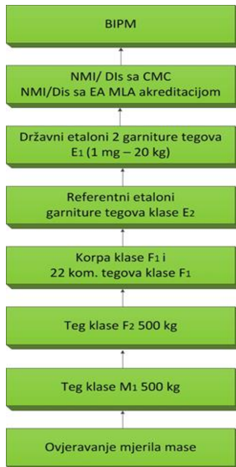
Slika 2. Lanac sljedivosti u oblasti mjerenja mase Laboratorije za velike mase
