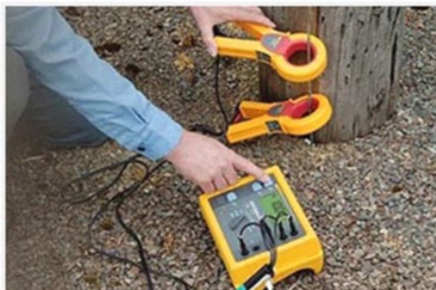
Testiranje gromobranske instalacije
