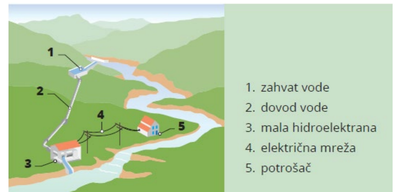
Najčešći raspored osnovnih elemenata male hidroelektrane
