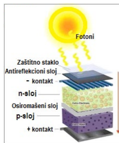
Struktura FN ćelije
