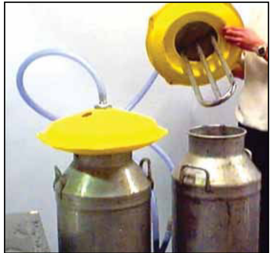
Hlađenje mlijeka u kantama sa rotacionim hladnjakom
