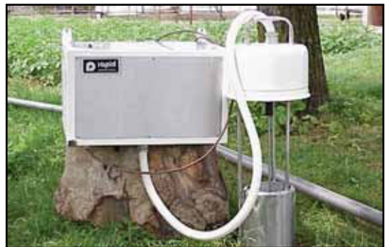
Hlađenje u kantama sa potopnim hladnjakom
