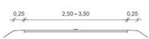
Slika 8. Dimenzije biciklističkog puta
