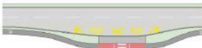
Slika 37. Vođenje biciklističke staze uz autobusko stajalište izgrađenog van kolovoza
