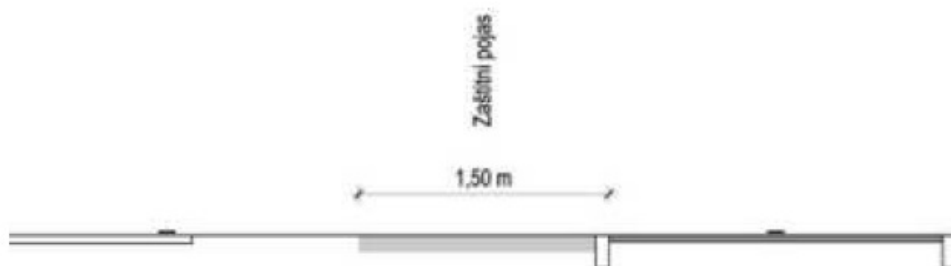
Slika 12. Zaštitni pojas biciklističke staze uz prostor za uzdužno parkiranje
