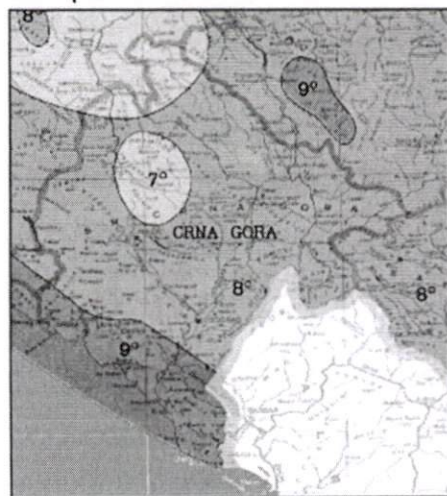
Slika : Privremena seizmološka karta teritorije SFRJ (dio za Crnu Goru) sa elementima očekivanog maksimalnog intenziteta zemljotresa, za povratni period od 500 godina (1987. godina). (Izvor: Sektorska studija za potrebe izrade PP R C SS-AE 4.12 ELEMENTARNE NEPOGODE I RIZIK OD TEHNIČKIH AKCIDENTATA, GTZ, Vlada RCG, RZUP, Univerzitet Crne Gore, Podgorica, april 2005)
