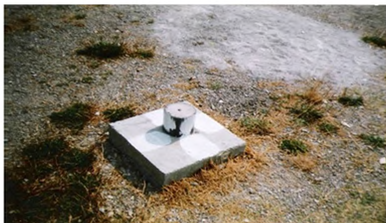
Slika 1.3. Način stabilizacije tačaka državne referentne GPS mreže.
