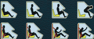
Simulacija kretanja tijela vozača pri frontalnom sudaru bez korišćenja sigurnosnog pojasa i sa sigurnosnim pojaskom.
