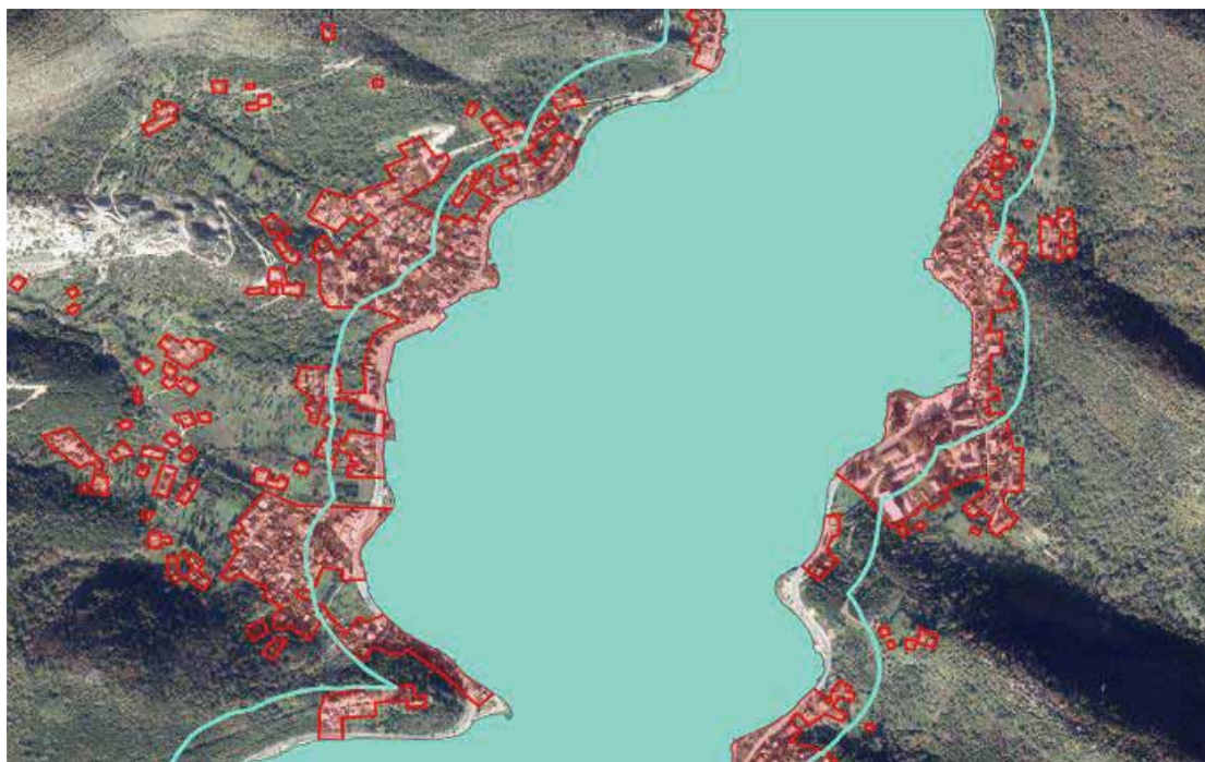
Slika 2. Primjer linije odmaka (tirkizna linija), izgrađenih i neizgrađenih područja u dijelu opština Herceg Novi i Tivat (preuzeto iz 5 )
