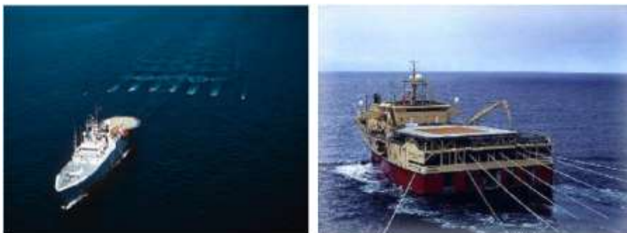
Slika 3.5 Primjer brodova za 3D seizmička istraživanja
