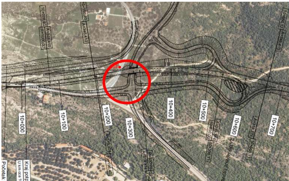
Slika II-10: Smanjena preglednost u raskrsnici s podvožnjakom
