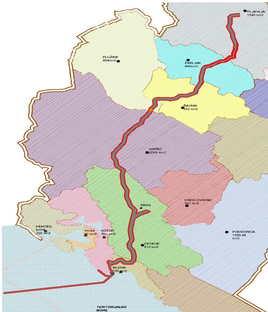
Slika 2. Zahvat DPP koridora dalekovoda od crnogorskog primorja do Pljevalja i podmorski kabal Italija - Crna Gora
