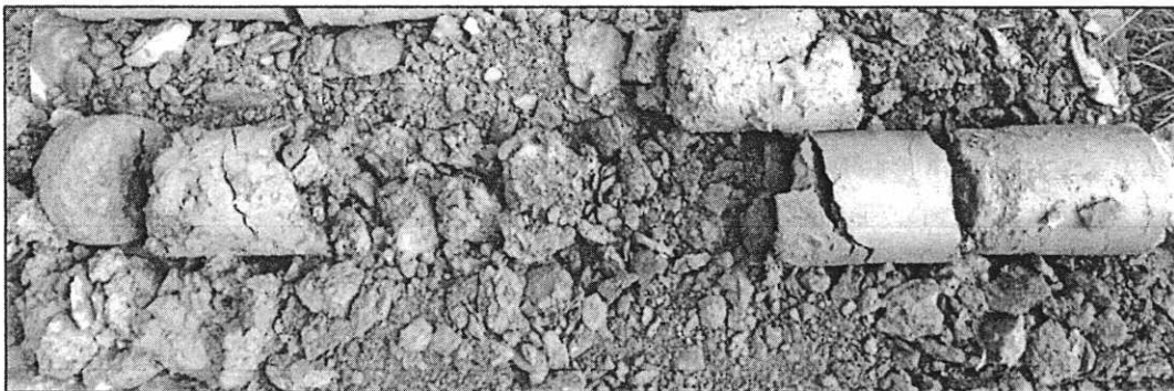
Slika 5. Alterisani flišni sedimenti, istražna bušotina B-3
