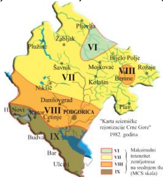
Karta seizmičke rejonizacije Crne Gore sa indicijom maksimalnih očekivanih intenziteta zemljotresa (Merkalijeva MCS skala) u periodu od 100 godina.
