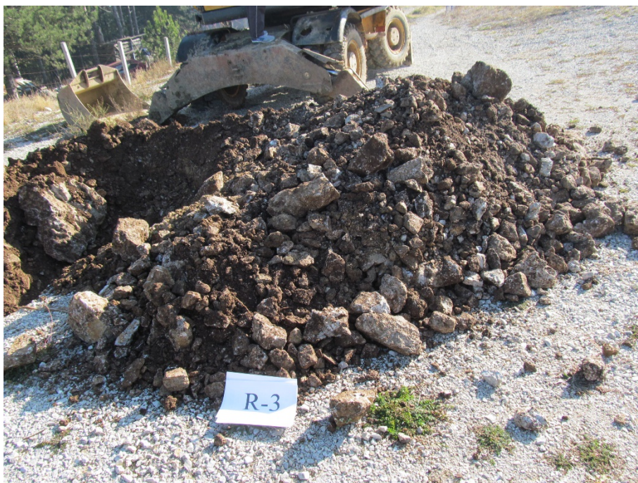
Materijal iz istražnog raskopa Rbo-3
