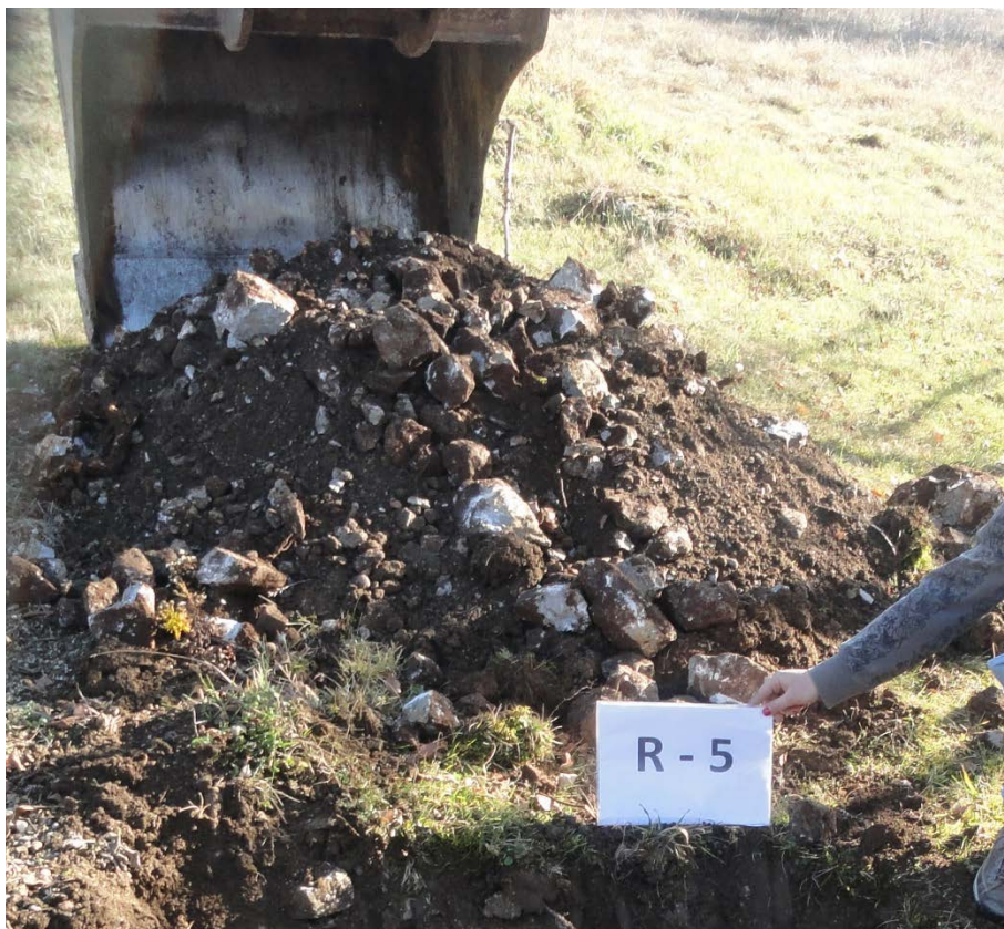
Materijal iz istražnog raskopa Rp-5
