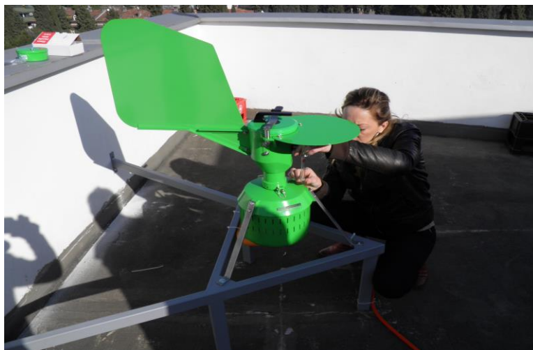
Slika 6. Provjera protoka vazduha mjernog instrumenta
