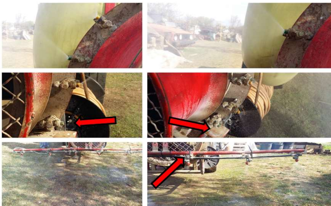
Slika 9. Prikaz neispravnih dizni (rasprskivača) na atomizeru i priključnoj traktorskoj prskalici
