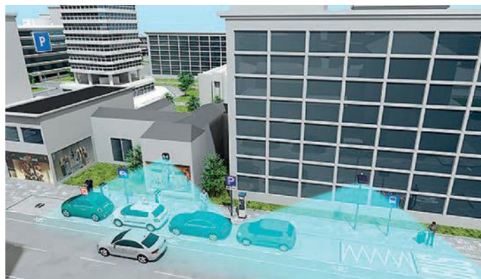
Slika 10. Primjer lokacije senzora na postojećim objektima
