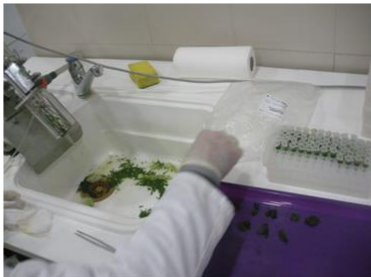
Sl. 6. Homogenizacija uzoraka lišća krompira
