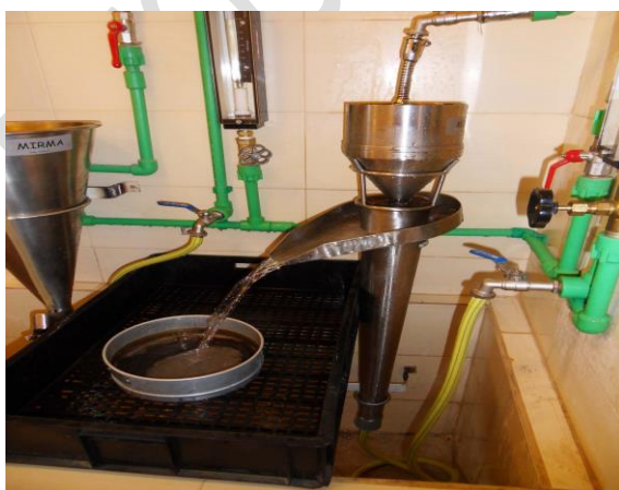
Slike 03-04.: Procesuiranje uzoraka KCN u laboratoriji. Slike 03 i 05 sušenje uzoraka; 04 elutriator Kort's-ovog tipa sa sitom u toku rada i 06 zemljište uhvaćeno na sitima koje se proverava na prisustvo KCN.
