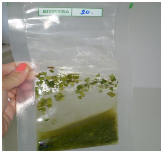
Sl.1: Fragmenti nadzemnih biljnih organa u kesi za maceraciju (Photo: Radunović Dragana)
