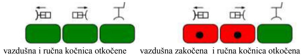
Slika 3: Pokazivač stanja vazdušne kočnice
