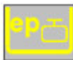
Slika 16: Oznaka za kočnicu za slučaj opasnosti sa mogućnošću odgađanja djelovanja sa ep upravljačkim vodom
