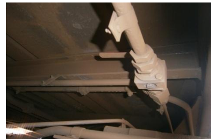
Sl.5.2 isključni položaj koji aktivira parkirnu kočnicu
