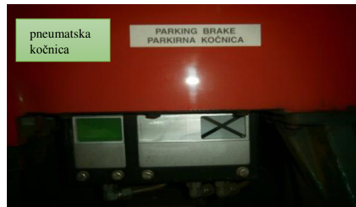
Slika 9. Indikator za parkirnu i pneumatsku kočnicu
