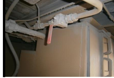
Sl.4.2 isključni položaj koji aktivira parkirnu kočnicu
