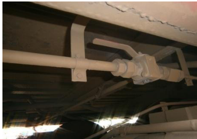
Sl.5.1. pravilan položaj u vožnji uključena parkirna kočnica
