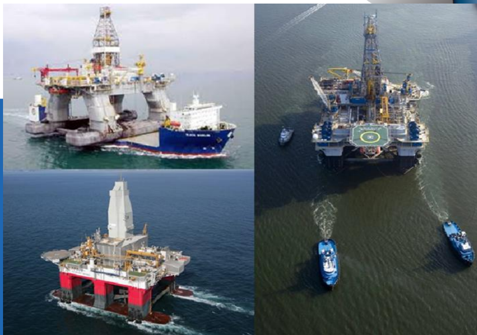
Slika 10. Princip transporta poluuronjene platforme na lokaciju. Transport brodom (gore- lijevo); Samostalno kretanje platforme (dolje- lijevo); Odvlačenje platforme na lokaciju tegljačima (desno)
