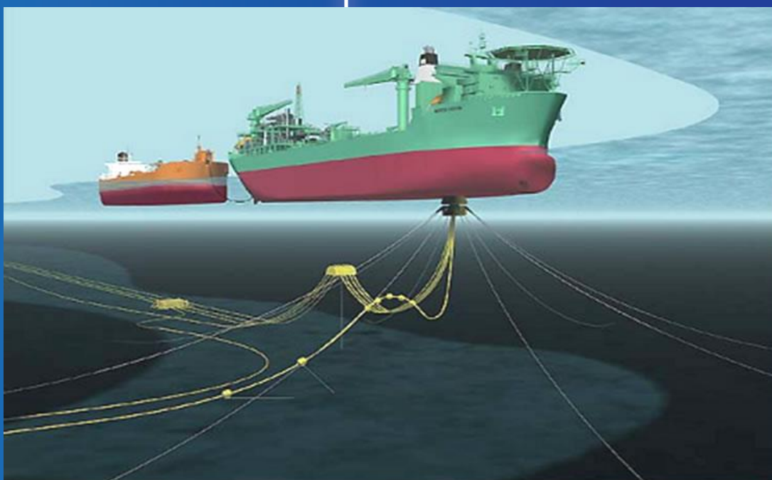
Slika 14. FPSO - prepumpavanje sirove nafte u tanker
