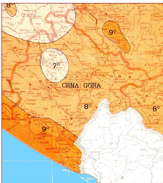
Slika: Privremena seizmološka karta teritorije SFRJ (dio za Crnu Goru) sa elementima očekivanog maksimalnog intenziteta zemljotresa, za povratni period od 500 godina (1987. godina)
