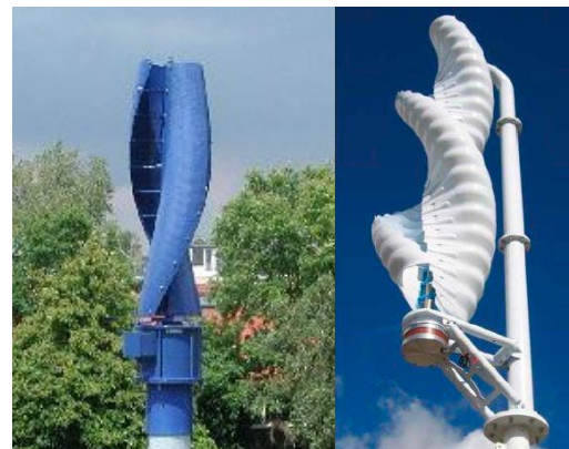
Spiralna Savoniusova vjetroturbina
