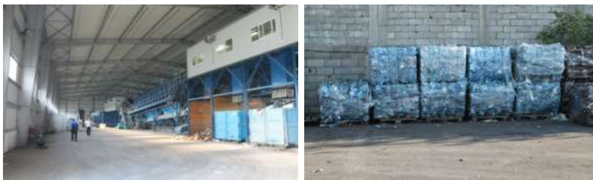
Slika 15. Deponija „Livade“ u Podgorica (pogon za primarnu reciklažu, presovana i balirana plastična ambalaža) 10
