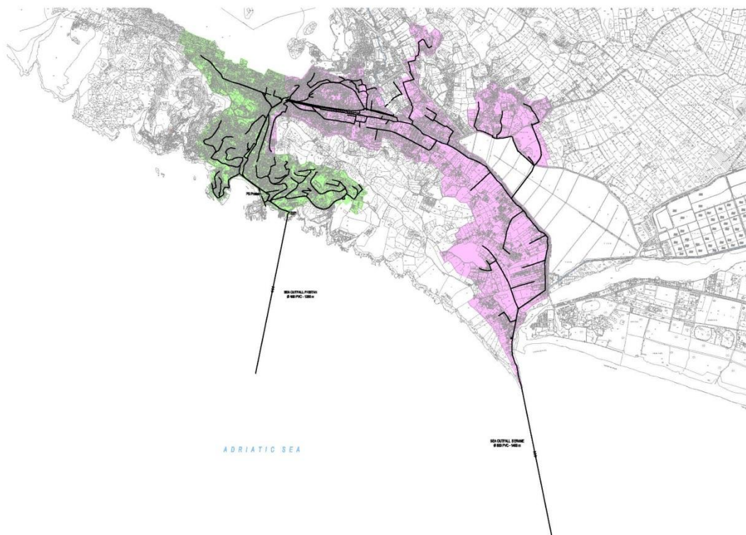
slika: Postojeći kanalizacioni sistem u Ulcinju - zeleno: slivno područje podmorskog ispusta Pristan; magenta: slivno područje podmorskog ispusta Đerane (izvor: Studija izvodljivosti sistema vodosnabdijevanja i odvođenja otpadnih voda za opštinu Ulcinj, 2012)
