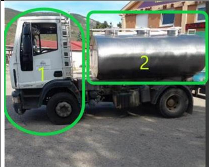
Integralni kamion sa rezervoarom za sakupljanje sirovog mlijeka/ vozilo za transport tereta/mlijeka u specifičnim uslovima – niske temperature
