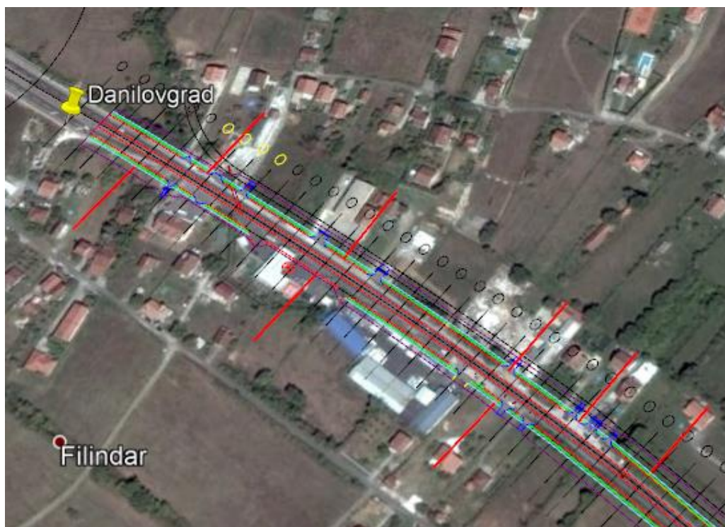
Slika 8.2.1: Područja sa stambenim objektima u kojima se očekuje negativni uticaj buke na stanovništvo nakon rekonstrukcije magistralnog puta M-18 Danilovgrad-Podgorica (od st. 114 + 527 do km 115 + 430, desno i lijevo od puta).
