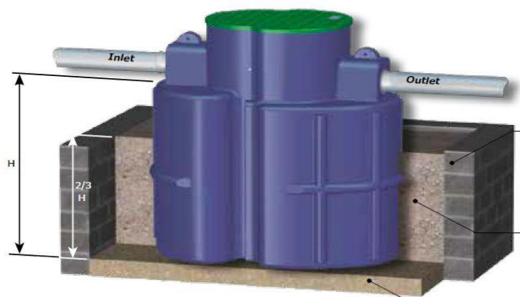
Slika 4.6: Separator ulja i masti
