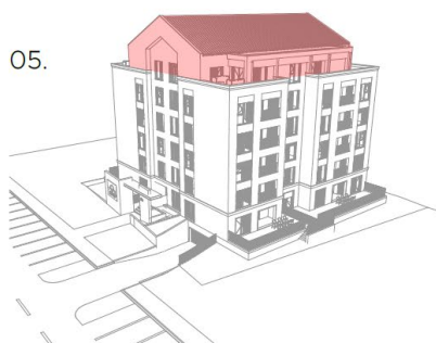
POTKROVLJE Planskim dokumentom je predviđena izgradnja potkrovlja kao završne etaže. Projektanti je ovo iskoristio kako bi dobio dinamičniju formu objekta.
