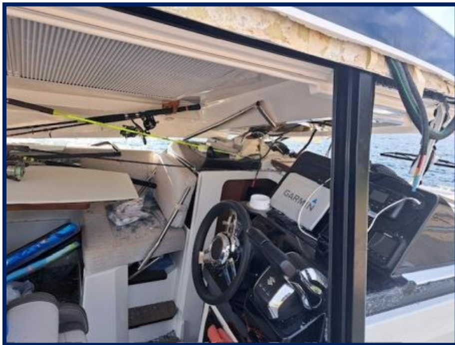
Slika 20. Oštećenje nadgradja motorne jahte MNE 0904
