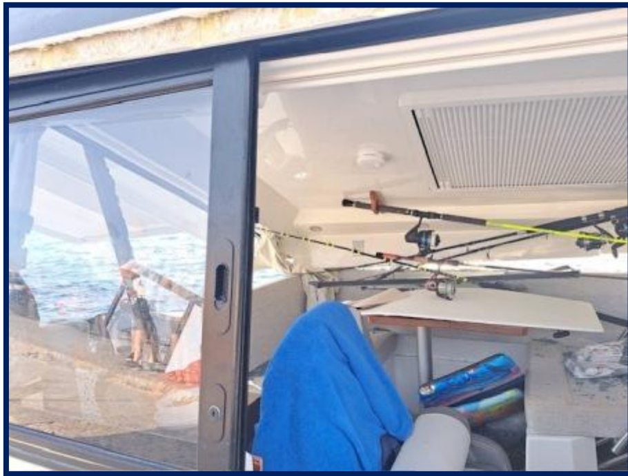
Slika 21. Oštećenje nadgradja motorne jahte MNE 0904
