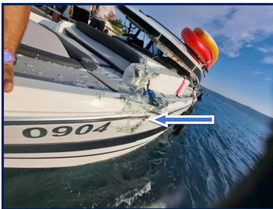
Slika 14. Mjesto prvog kontakta na jahti po lijevoj pramčanoj strani sa čamcem 224 -KT
