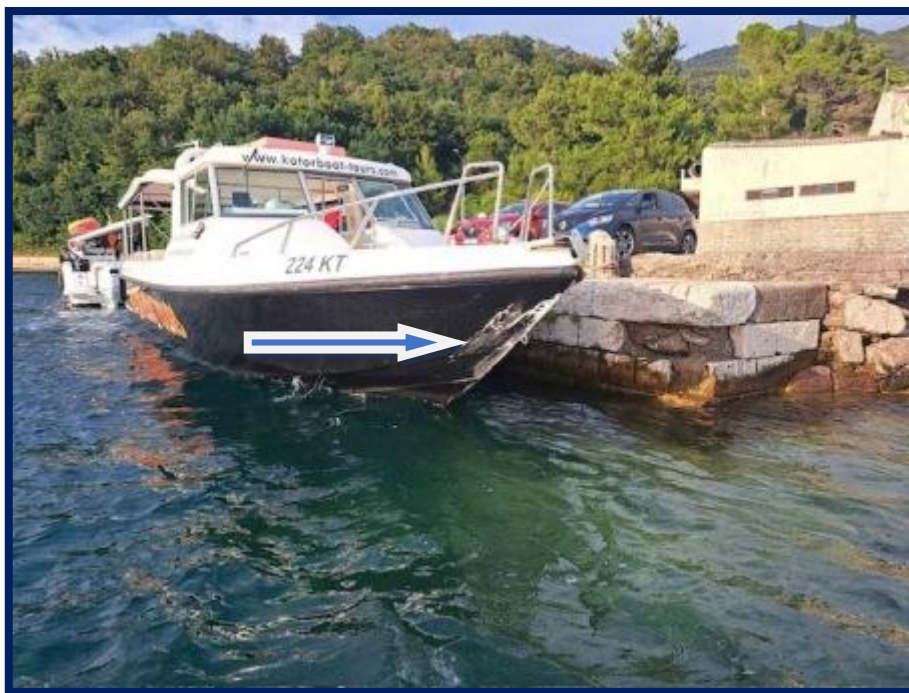
Slika 6. Pramčano oštećenje na čamcu registarskih oznaka 224-KT
