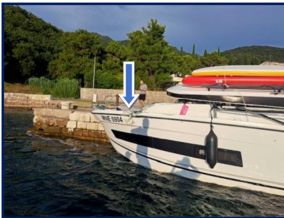
Slika 9. Mjesto prvog kontakta na jahti po lijevoj pramčanoj strani sa čamcem 224 -KT
