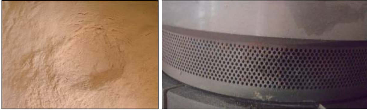
Slika 28. Izgled pripremljene sirovine za proizvodnju peleta (levo) i matrice (desno)
