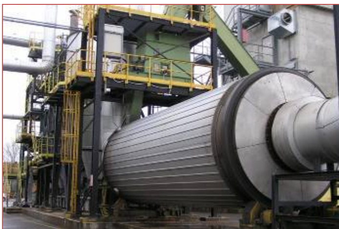
Slika 27. Izgled rotacione sušare (foto: B. Glavonjić, 2010. god.)
