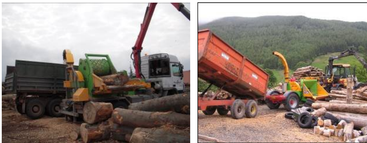
Slika 20. Pokretna drobilica sa sopstvenim pogonom (levo) i pogonom na traktorsku osovinu (desno) (foto: B. Glavonjić)
