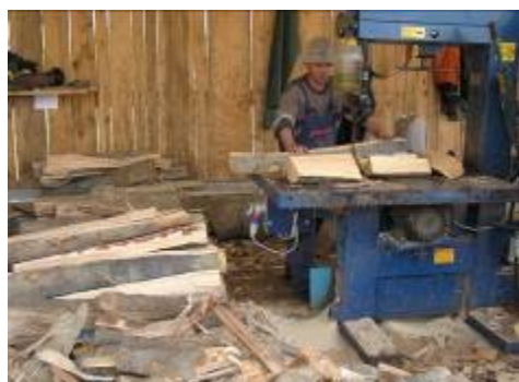
Slika 9. Faze tehnološkog procesa proizvodnje cepanog drveta (postupak I)
