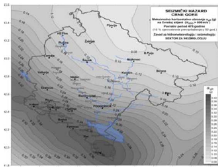
Slika 3. Izolinije referentnog horizontalnog ubrzanja tla a_{gR} u djelovima gravitacionog ubrzanja Zemlje g ( g = 9,81 \text{ m/s}^2 ) za povratni period od 475 godina (vjerovatnoća prevazilaženja događaja 10% u 50 godina)
