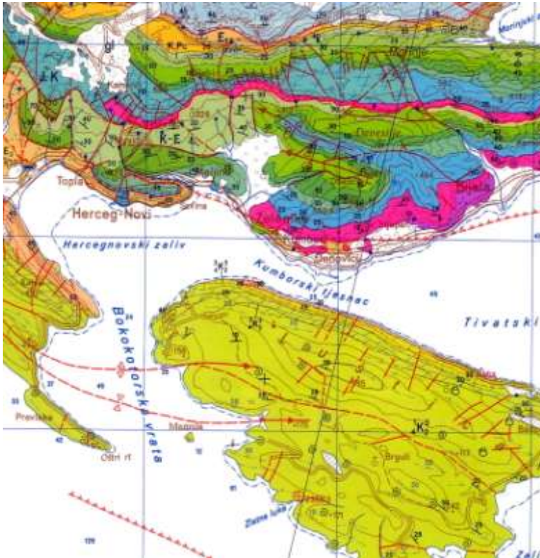
Slika 6. Prikaz geološke karte šireg prostora Herceg-Novskog zaliva (LEGENDA: trijas: T_2^1 – fliš, T_{2,3} – krečnjaci sa proslojcima dolomita; jura: J – krečnjaci sa rožnacima i dolomitima; jura-kreda: J,K – bankoviti dolomiti; kreda: K_1 – krečnjaci, K_{2^{1,2}} – krečnjaci sa proslojcima krečnjačkih breča, K_{2^{2,3}} – krečnjaci sa rožnacima, {}^1_4K_2^3 – bankoviti i slojeviti krečnjaci sa proslojcima dolomita; kreda – paleogen: K-E – prijelazni slojevi u podini fliša i fliš, K,Pc – foraminiferski krečnjaci; paleogen: E_1 – fliš, E_3 – fliš) (Izvod iz OGK 1:100 000, list Kotor, grupa autora, 1969.)
