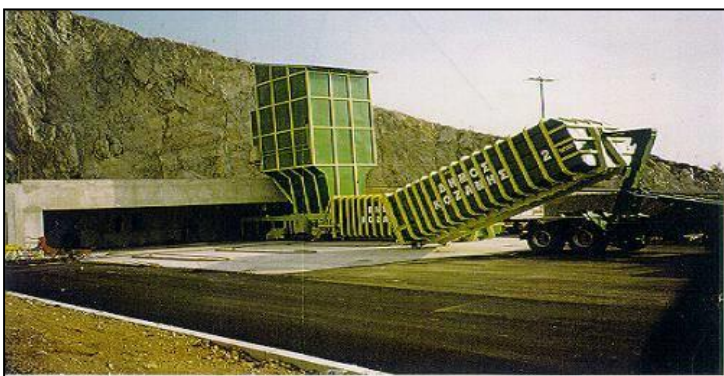
Slika 3: Uklanjanje kontejnera sa transfer stanice
