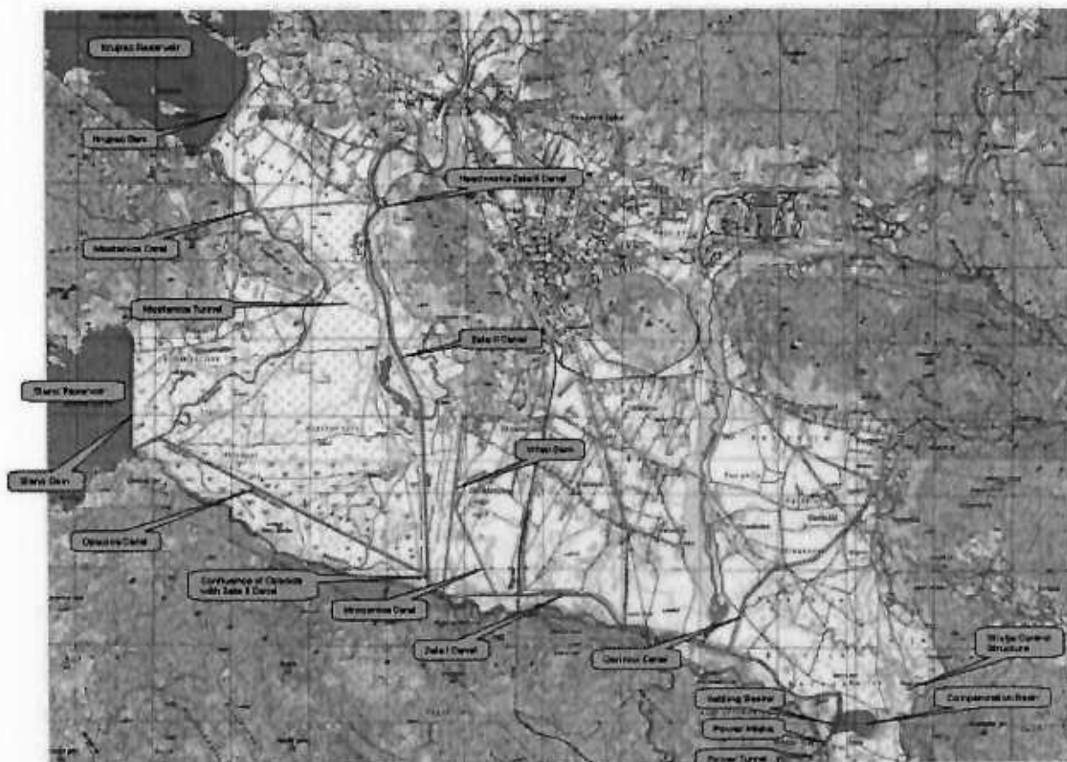
Slika: Prikaz dovodnih objekata u sistemu HE Perućica
