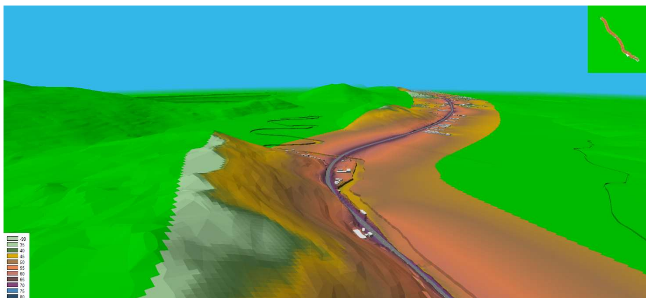
Slika 6: 3D model terena sa saobraćajnicom i prikazom nivoa buke
