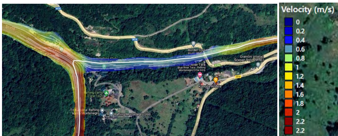
Слика 2.2.1. Мапа брзина течења за стање са ХЕ „Бук Бијела“ са акумулацијом на коти 434 mnm - хидролошки сценарио Q_{inst\ ХЕ\ Пива}=240\text{ m}^3/\text{s} и Тара Q_{sr} – корито ријека Дрине, Таре и Пиве на пограничном потезу
