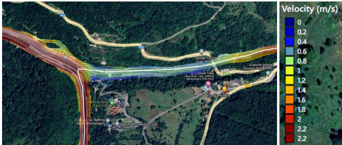
Слика 2.1.3. Мапа брзина течења за постојеће стање Q_{inst\ ХЕ\ Пива}=240\text{ m}^3/\text{s} и Тара Q_{sr} , на потезу саставци – корито ријеке Таре и Пиве на пограничном потезу, без изграђене ХЕ „Бук Бијела“
