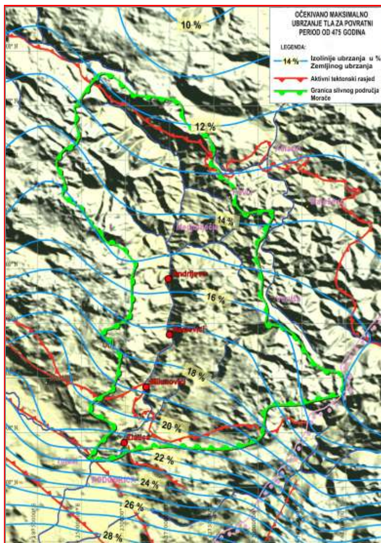
Slika 8. Karta očekivanog maksimalnog (horizontalnog) ubrzanja tla na osnovnoj stijeni (izraženo u procentima ubrzanja sile zemljine teže) za povratni period od 475 godina, za cijelo slivno područje rijeke Morače i neposrednog okruženja. Lokacije brana prikazane su crvenim kružnim simbolima. Ova karta u većoj razmjeri prikazana je na Prilogu 1.
