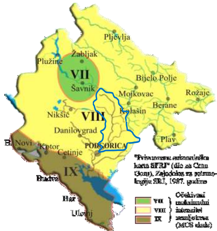
Slika 1. Seizmološka karta za povratni period od 500 godina (dio za Crnu Goru) kao prilog Tehničkim normativima za izgradnju objekata visokogradnje u seizmičkim uslovima sa približnim položajem konture slivnog područja rijeke Morače (plava zatvorena linija).
