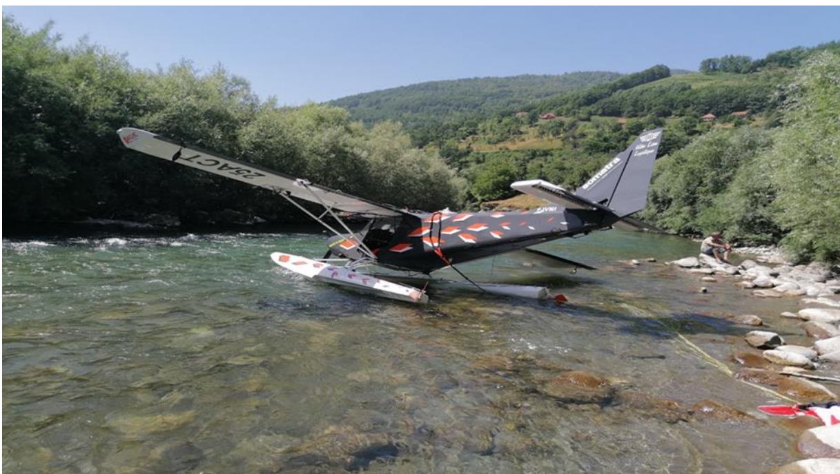
Slika br. 11 – Kolaps desnog plovka vazduhoplova
