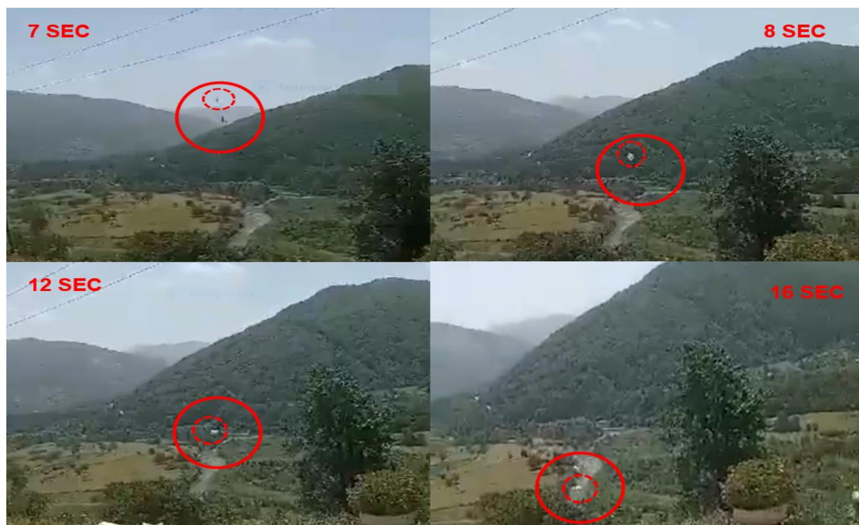
Slika br. 8 – Aktiviranje i raztvijanje BRS sistema i spuštanje aviona u korito rijeke Lim
