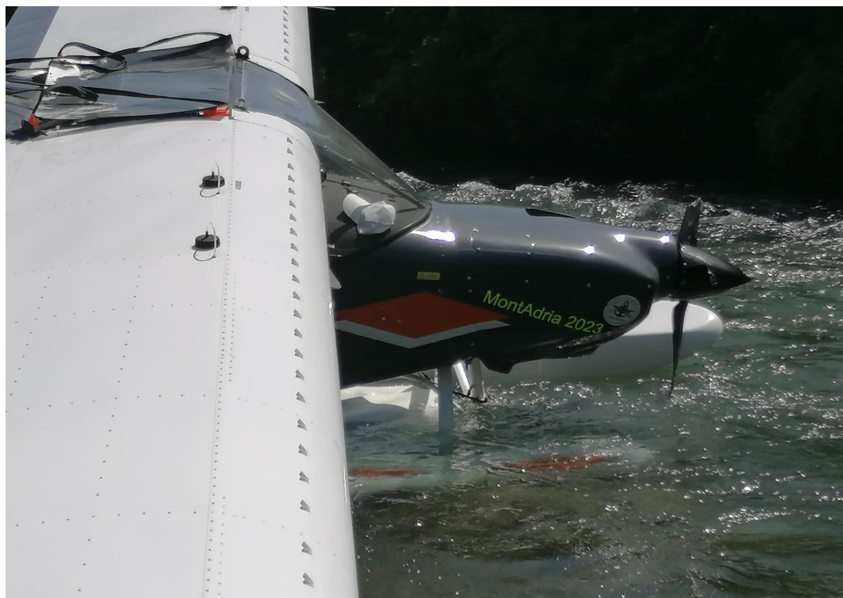
Slika br. 12 – Motorski dio aviona sa propelerom i polomljenom lopaticom
