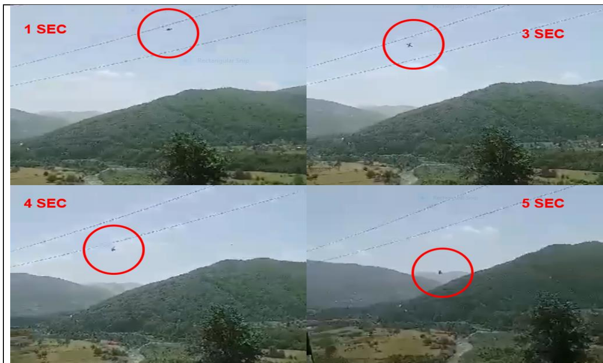
Slika br. 7 – Nagli pad aviona u nepravilni položaj do momenta aktiviranja BRS sistema
