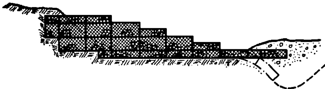
Slika 52 – Naper od gabiona
