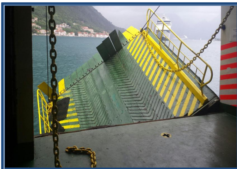
Slika 7. Ukrajno iskrajna rampa nakon nezgode
