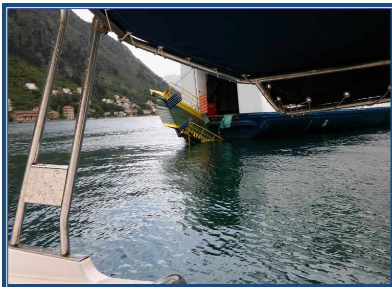
Slika 5. Iskrcajno ukrcajna rampa nakon nezgode
