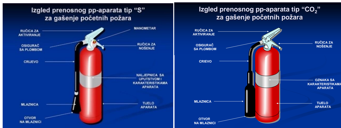
Slika 1. Izgled ručnog prenosnog aparata za početo gašenje požara, tip S-9A i CO 2 -5 kg
