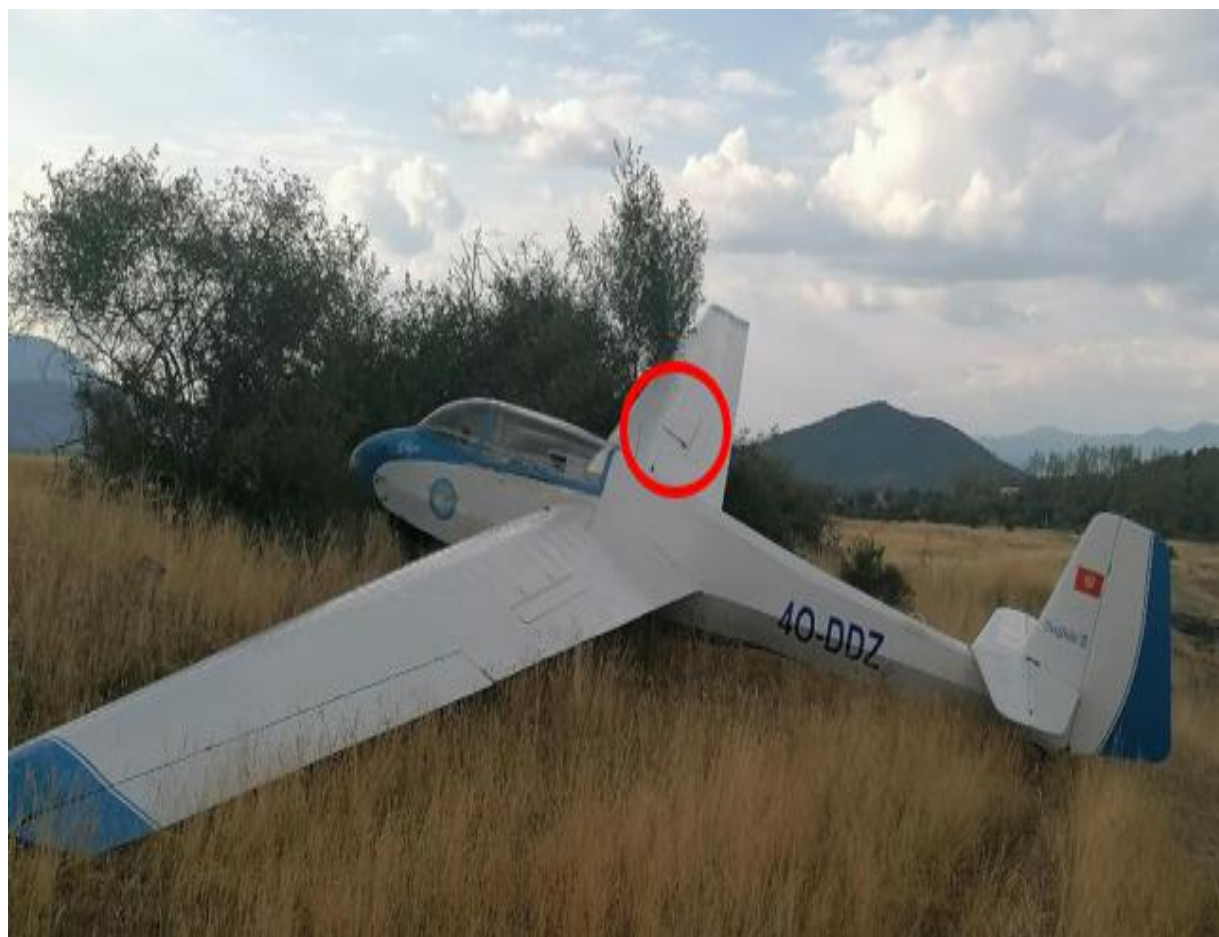
Slika br. 5 – Oštećenje (poderotina) oplata gornjake desnog krila vazduhoplova
