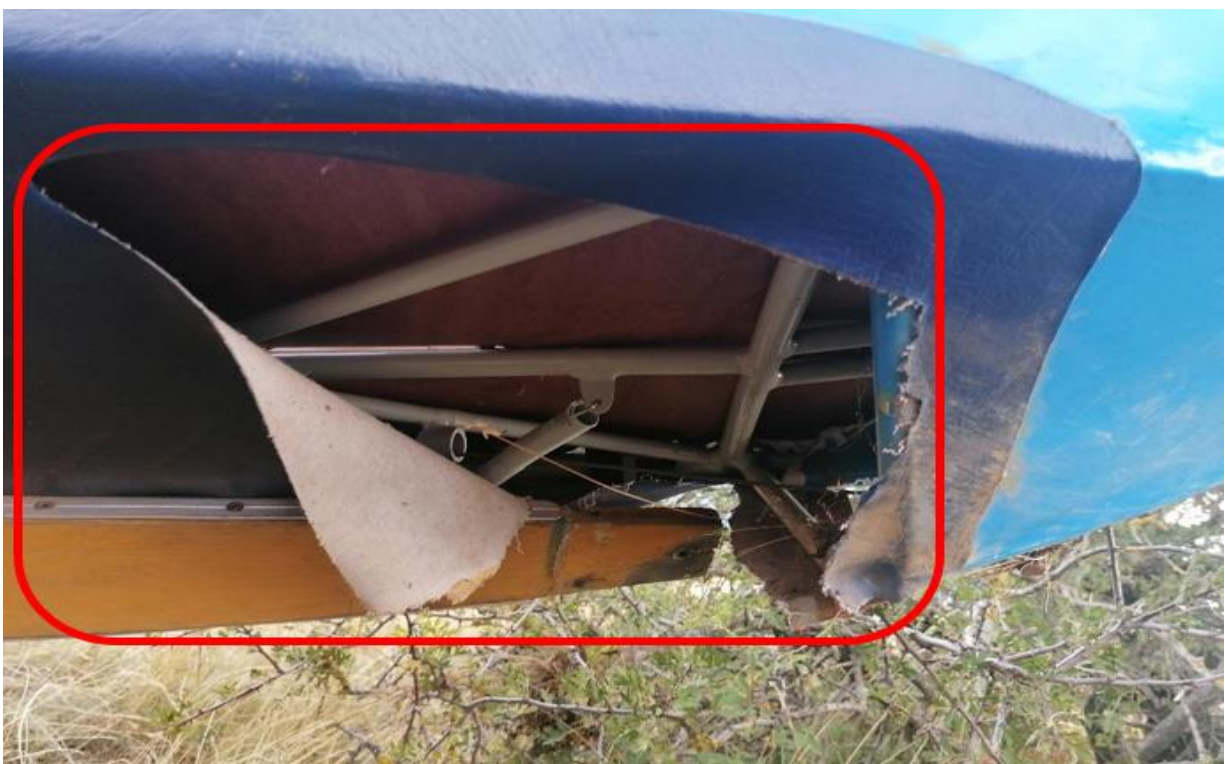
Slika br. 7 - Oštećenja donje plsatnene oplate kabinskog dijela trupa vazduhoplova
