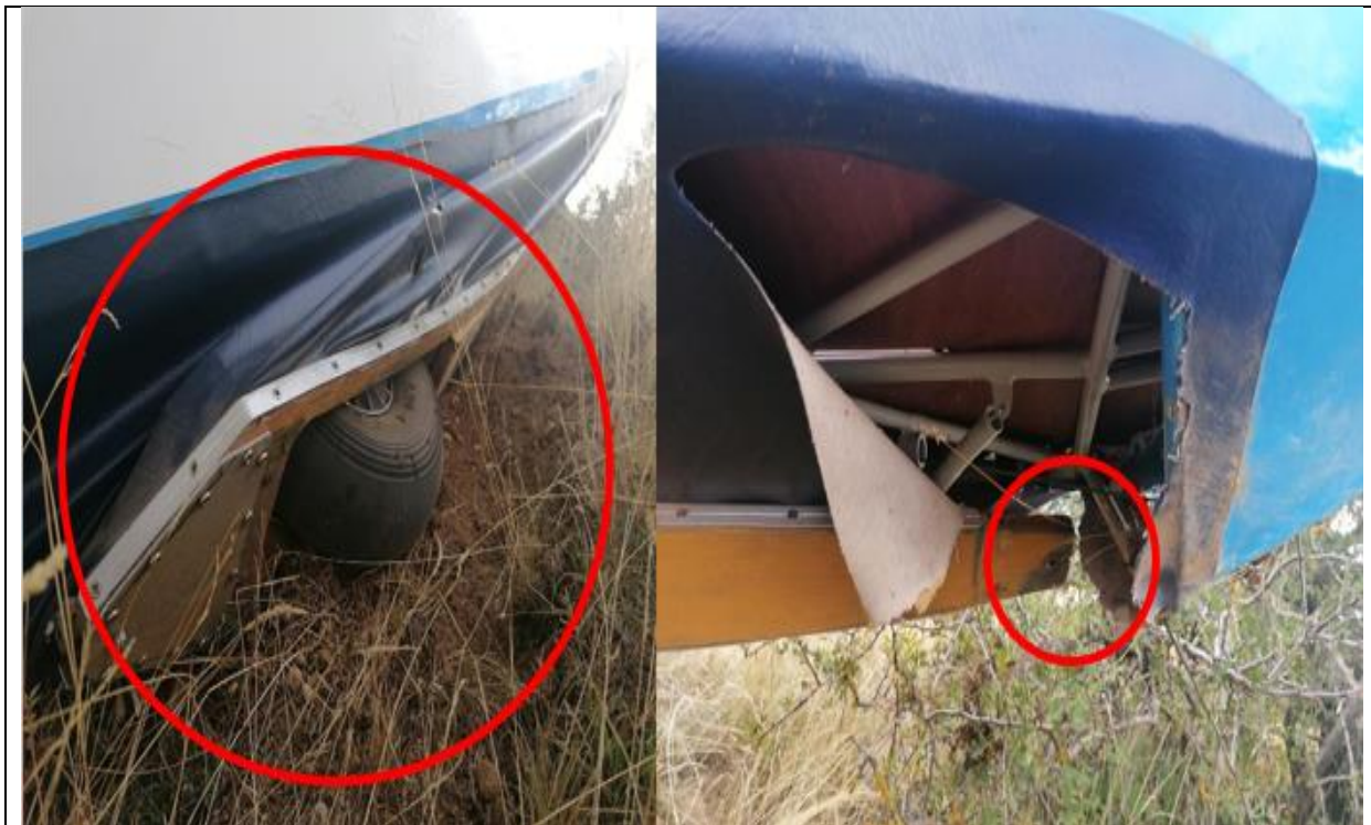
Slika br. 6 - Oštećenja glavne noge stajnog trapa vazduhoplova
