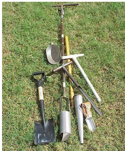
Slike: Alatke za uzimanje uzoraka zemlje u nematologiji
