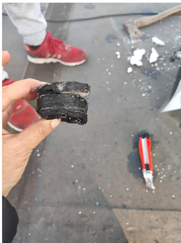
Izgled slojeva ispod krovne mebrane i polistirena d=10\text{cm} – Slojevi ravnog krova iz perioda izgradnje: mjerenje debljine postojeće bitumenske izolacije
