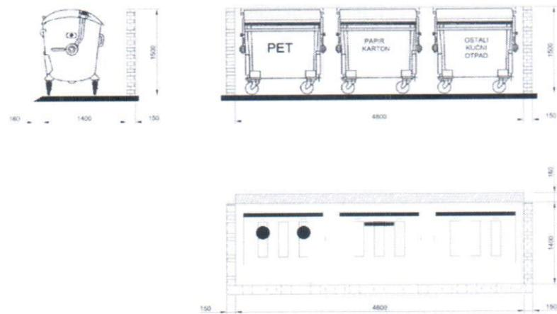
Prilikom realizacije ovih kontejnerskih mjesa voditi računa da kontejneri budu smješteni na izbetoniranim platoima ili u posebno izgrađenim nišama (betonskim boksovima)
