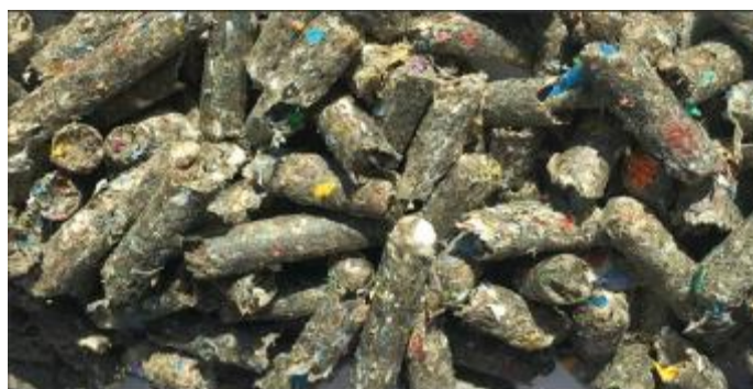
Slika 6 RDF gorivo prešano u pelete
