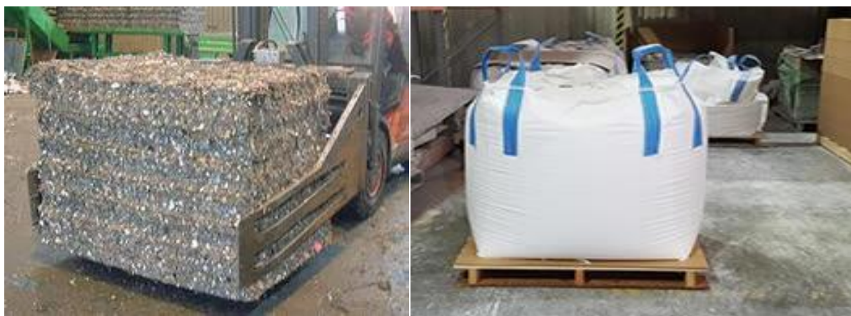
Slika 5 Prikaz prešanih bala RDF goriva (lijevo), te big-bag vreća za transport peleta (desno)
