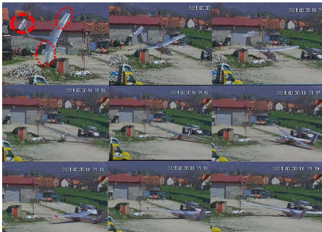
Slika br. 3 – Putanja vazduhoplova u nekontrolisanom letu do zaustavljanja na zemlji
