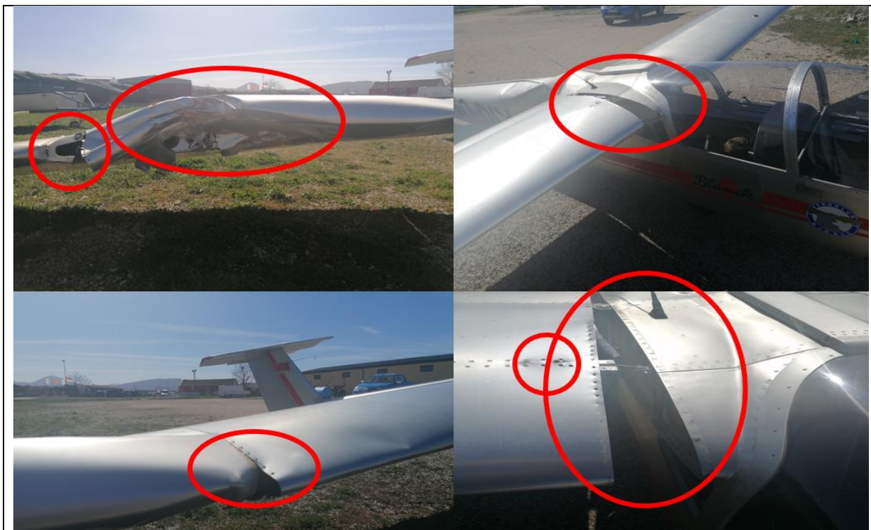
Slika br. 7 - Oštećenja desnog krila vazduhoplova
