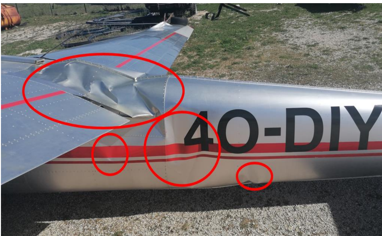
Slika br. 8 – Oštećenja trupa po lijevoj strani vazduhoplova
