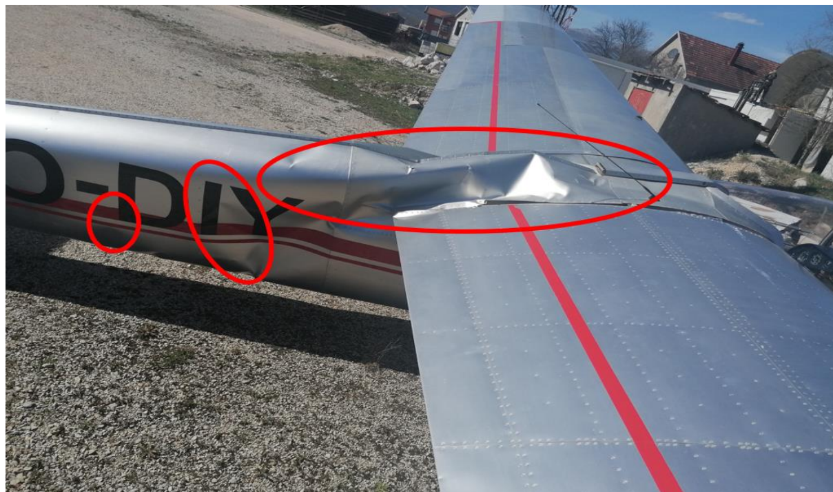
Slika br. 6 - Oštećenja desne i gornje strane trupa vazduhoplova
